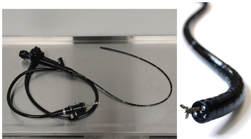
Vue d'ensemble d'un endoscope flexible standard (à gauche) et vue de la partie distale avec la caméra, les fibres optiques d'illumination et le canal opérateur dans lequel on trouve une pince à biopsie insérée
